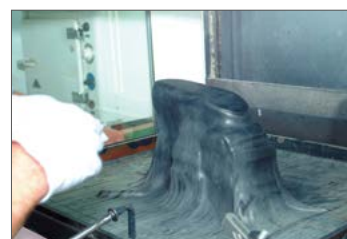
oder mittels Vakuum verformen.
