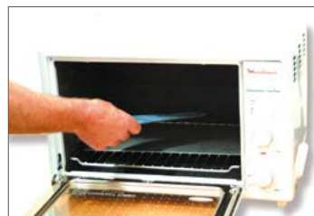
Bauteil 4 - 6 min bei ca. 140° C im Ofen erwärmen.
